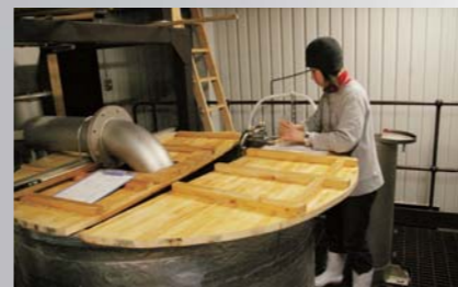
粉碎麦芽とお湯を混ぜて糖化を促進するマッシング工程。マッシュタンの容量は約2400ℓ。麦芽の状態を常にチェック。
