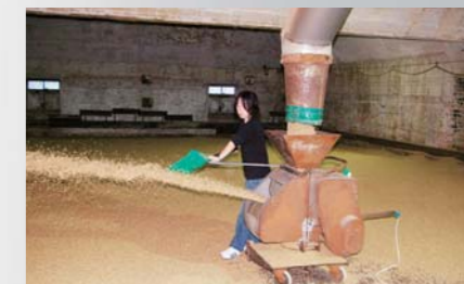
発芽を乾燥させるために、キルン内でスプレッダーを使って敷き詰める。スコップを使って飛ばす方向をコントロール。
