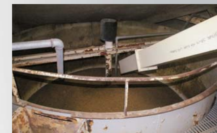
モルティングの最初のステップは大麦を水で浸漬する。ウェットとドライを繰り返す断続スティーピングを行う。
