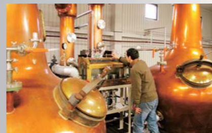
ウイスキー造りに必須の銅製のポットスチル。スチルマンが日々、香りと味を確かめ、樽詰めに最適な部分をハートとして取得。
