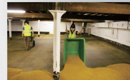
水分を十分含んだ大麦をフロアに敷き詰める。この時点での水分含有量は40%以上。
