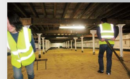
発芽を均一にするために、レイキを使ってモルトを攪拌。水分を含んだ大麦はかなり重く足に重労働。
